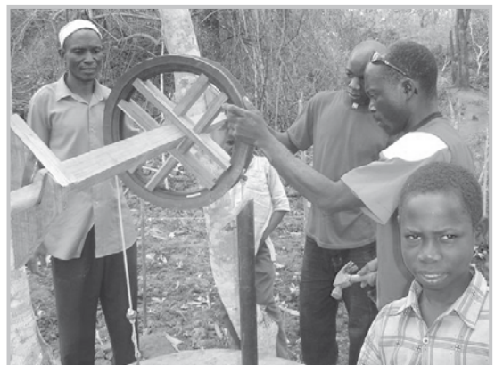
Uma bomba de corda de madeira foi desenvolvida e aqui produzida por carpinteiros no norte de Moçambique
