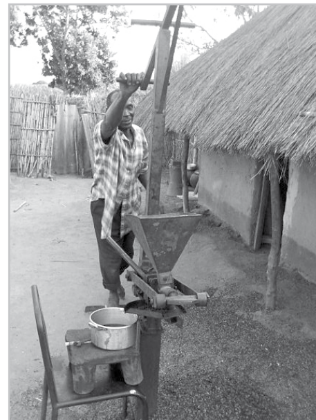
Prensa manual para produzir óleo de sementes
